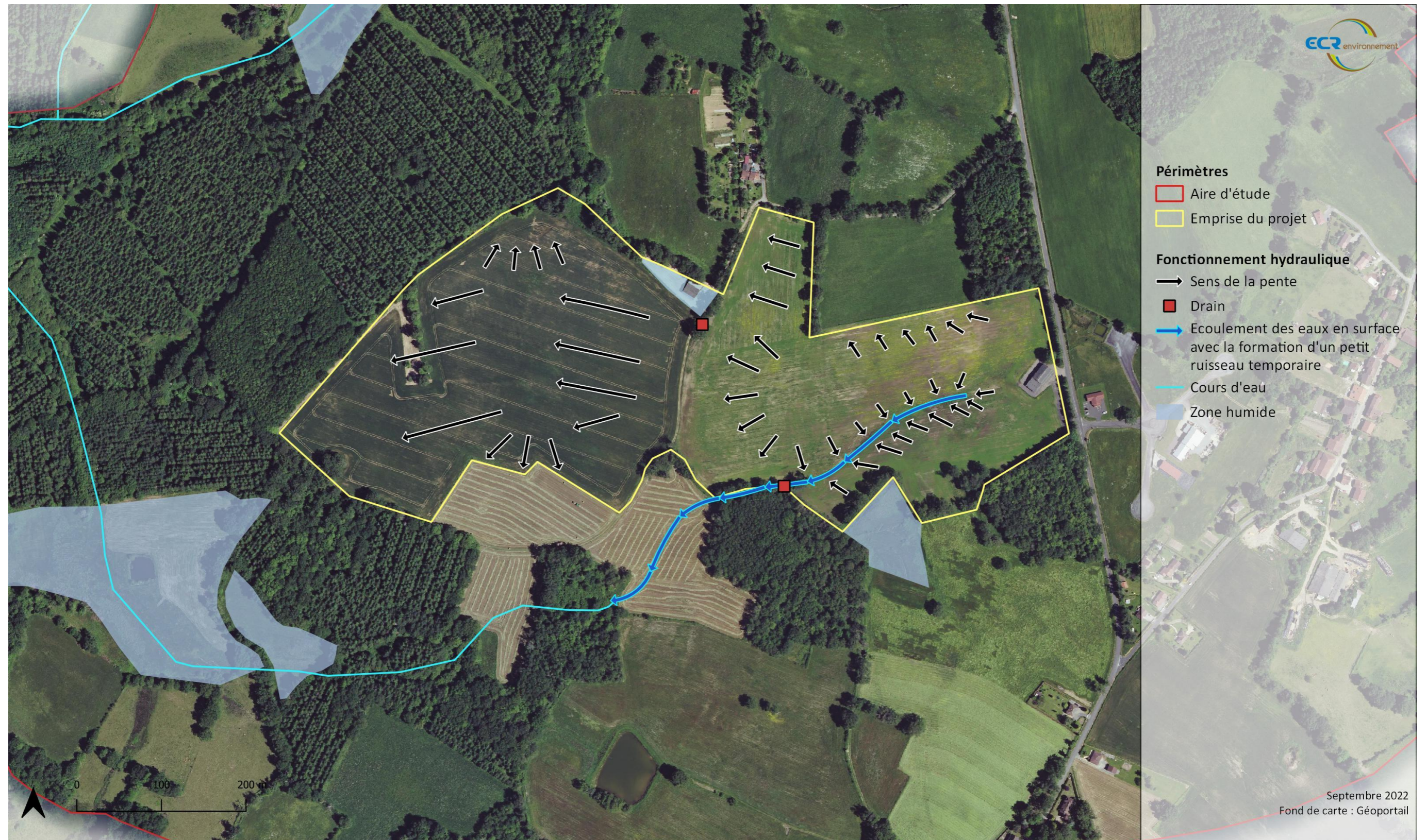
Figure 42 : Représentation schématique du fonctionnement hydraulique de la parcelle et de la localisation des zones humides au sein de l'aire d'étude
